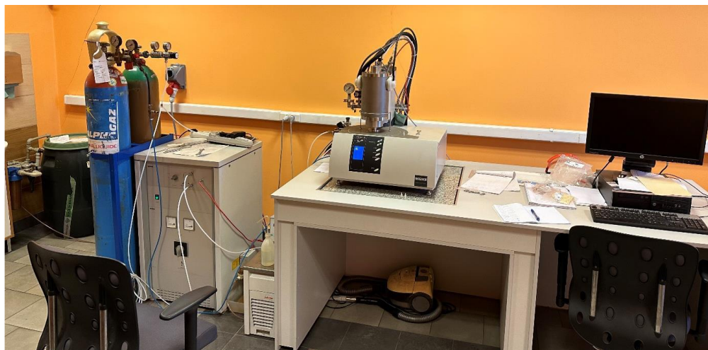
Analizator termograwimetryczny, model STA 449 F3 Jupiter, firmy NETZSCH.
