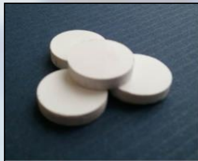
kształtki hydroksyapatytowe przygotowane do inkubacji w symulowanych płynach ustrojowych
