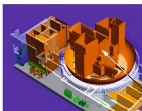
Prefabrykowany moduł konstrukcyjny CA01 złożony z 72 podzespołów - wymiary: 13 × 21 × 20.7 m - masa własna 777 ton
