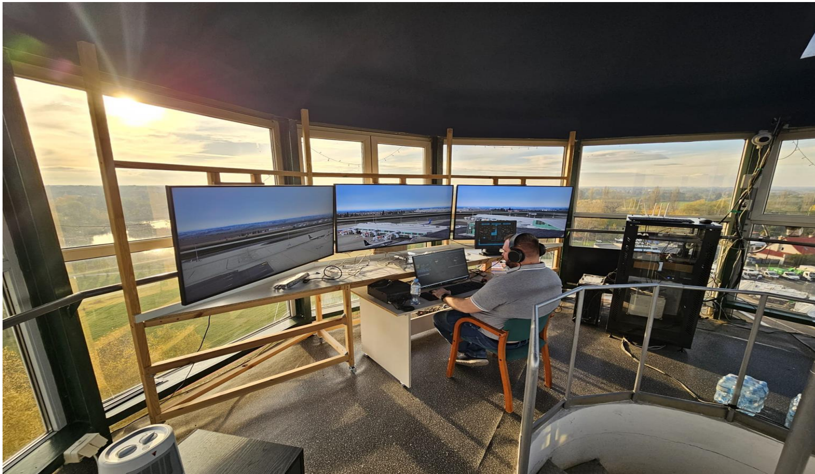
Symulator kontroli ruchu lotniczego – TWR4 Bisek Aerospace Ulokowany na wieży – 30 metrów nad ziemią.
